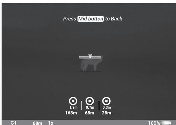
FIGURE 2-7. STADIAMETRIC RANGEFINDER
